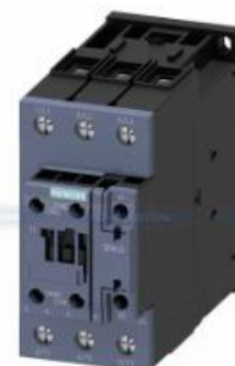
Contactor 3P, 110A, 220VAC, 3RT2047-1AL20 SIEMENS Contactor de fuerza tripolar, terminal tornillo, 110A, bobina 220V CA. 1 contacto abierto 1 contacto cerrado, Tamaño S3
