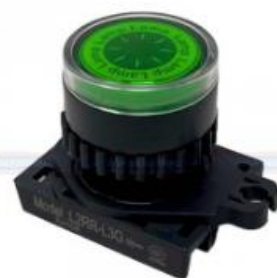
Cabeza Lámpara De Señalización Verde L2RR-L3G AUTONICS Cabeza de luz piloto color verde, montaje de 22 mm, material de plástico, sin LED integrado (se vende por separado)
