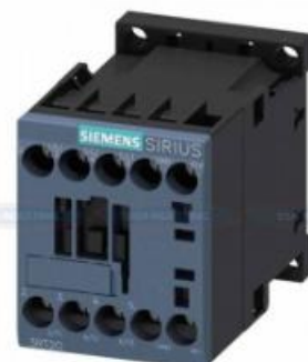
Contactor 3P, 12A, 24VDC, 3RT2017-1BB41 SIEMENS Contactor de fuerza tripolar, terminal tornillo, 12A, bobina 24V CD. 1 contacto abierto, Tamaño S00
