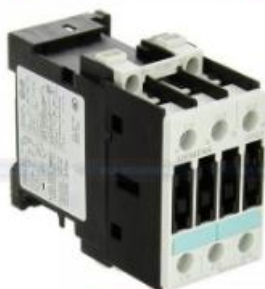
Contactor Tripolar 32A 440VAC 3RT10341AR16 SIEMENS 3RT1034-1AR16 SIEMENS CONTACTOR B-440V S2 32A C-AUX. 2NA+2NC MODELO: 3RT1034-1AR16 Contactor de potencia, 3 AC 80 A, 15 kW/400 V 115 V AC, 60 Hz 3 polos, Tamaño S2 Borne de tornillo
