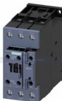
Contactor 3P, 110A, 115VAC, 3RT2047-1AK60 SIEMENS Contactor de fuerza tripolar, terminal tornillo, 110A, bobina 115V CA. 1 contacto abierto 1 contacto cerrado, Tamaño S3
